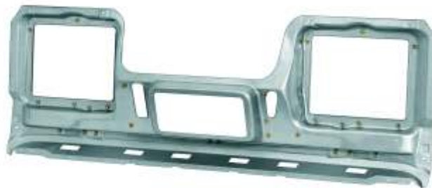
LKW Frontenteil mit 30 Einstanzmuttern, verarbeitet in einem Hub
