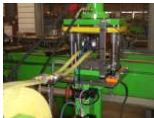
Zuführung der Einstanzmuttern über wiederbefüllbare Magazine
